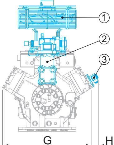
Ansicht X: Anschlussmöglichkeit für Ölspiegelregulator
